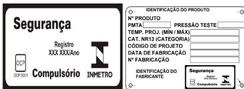
Figura 11 – Exemplo de placa de identificação com o Selo de Conformidade INMETRO
