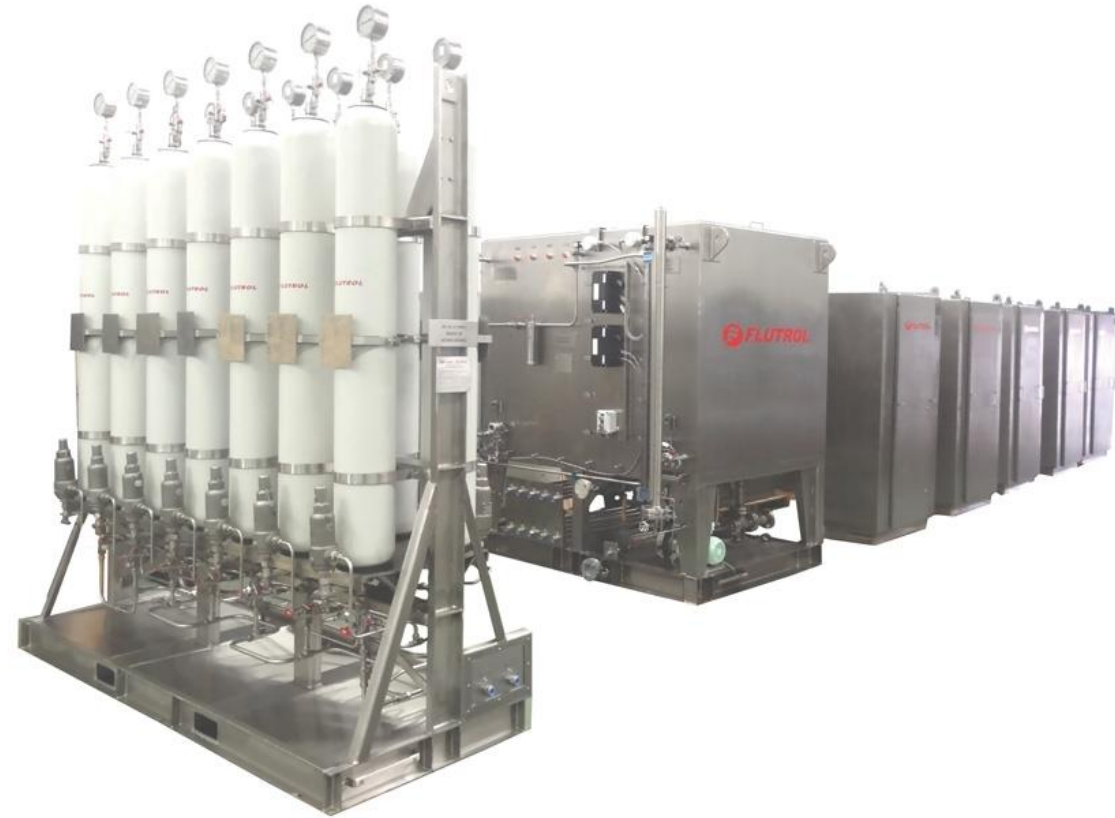
HPU Unidade Hidráulica + Acumuladores + Painel para controle de poço 12 volts. ( 7.500 psi) Cliente: Petrobrás -Cherne
