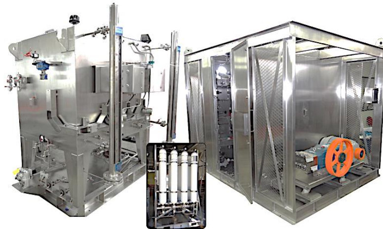
HPU Unidade Hidráulica + Acumuladores + Painel para controle de poço 12 volts. ( 7.500 psi) Cliente: Petrobrás -Cherne
