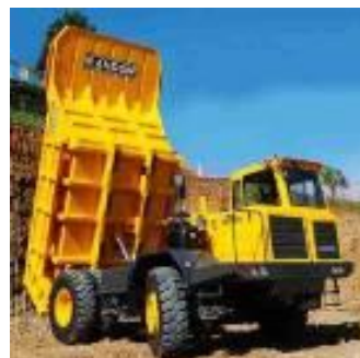
Caminhão Fora de Estrada
